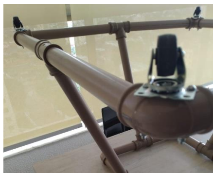
Figura 3- Detalhe de fixação da roldana
